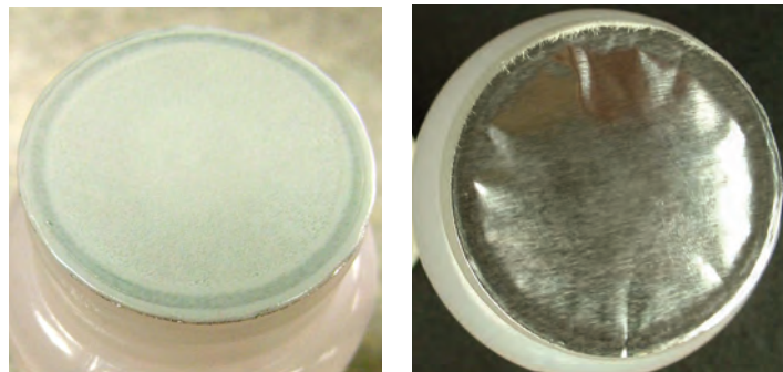
Un buen sello muestra adhesión alrededor de la boca del envase, no presenta decoloración y puede presentar un mínimo pliegue.
