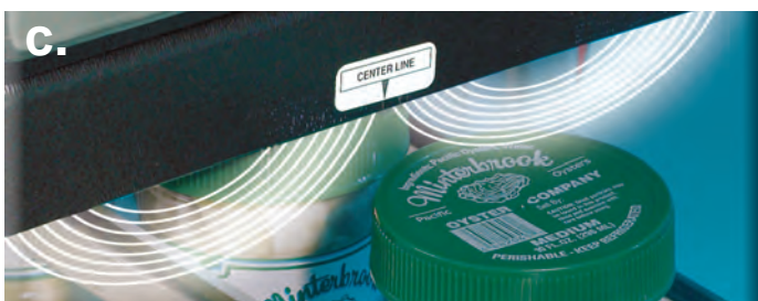
Dependiendo de la geometría de la tapa y del envase pueden ser necesarios diferentes tipos de cabezales de sellado para obtener un sello eficaz. La foto (arriba) muestra los cabezales de sellado más comunes: (a) Tipo túnel (b) Tipo Túnel Profundo (c) Plano (d) Cabezal universal
