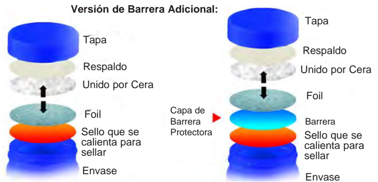
Un sello de 2 piezas unidas por cera, frecuentemente utilizado para aquellos productos volátiles o agresivos. Imagen cortesía de Selig.
