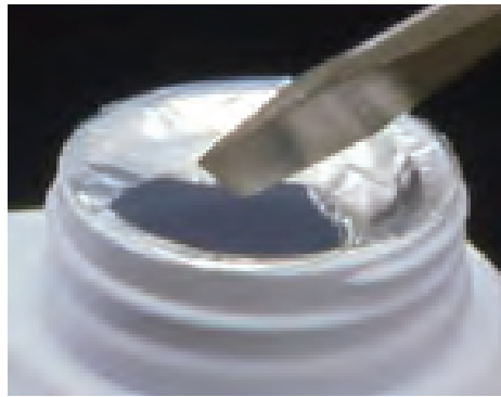
Características de remoción del sello - (I) El sello sale limpio, no deja residuos (M) El sello debe ser destruído para abrirlo. (D) Sello de fácil acceso, puede abrirse oprimiéndolo con 1 dedo.
