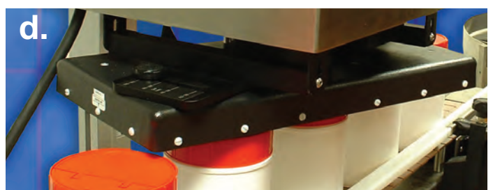
Dependiendo de la geometría de la tapa y del envase pueden ser necesarios diferentes tipos de cabezales de sellado para obtener un sello eficaz. La foto (arriba) muestra los cabezales de sellado más comunes: (a) Tipo túnel (b) Tipo Túnel Profundo (c) Plano (d) Cabezal universal
